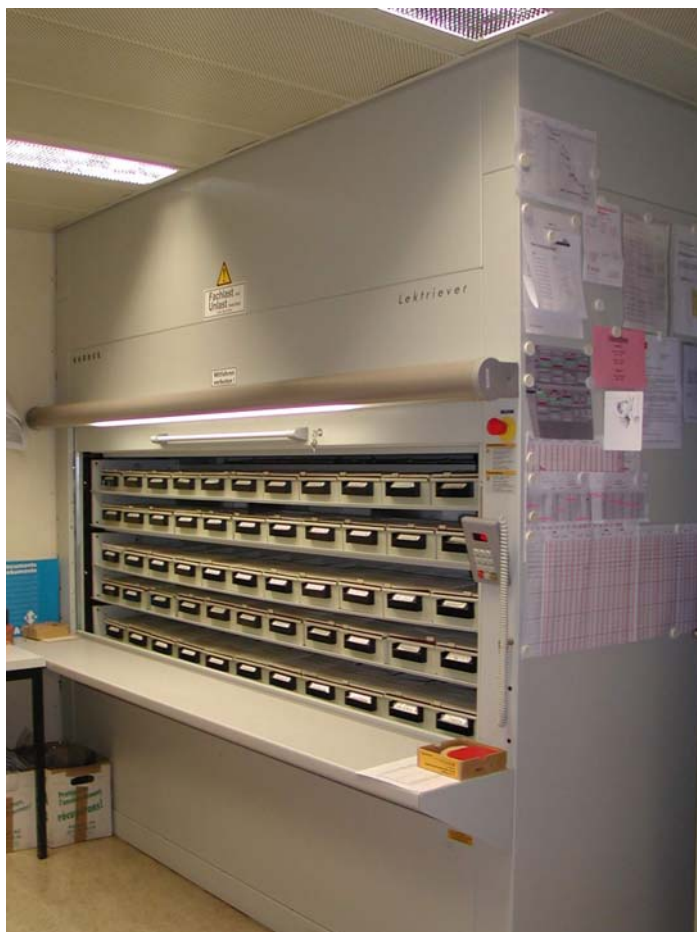
Lektriever® 120/19-12", Masse: 2560 x 3500 x 1155 mm (BxHxT) 38 Nutzebenen mit je 11 Kassetten, ca. 770'000 Mikrofilme
