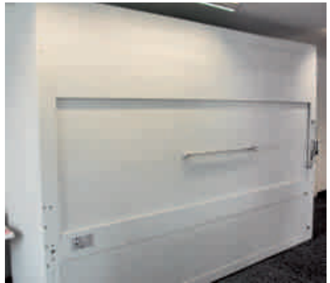
Lektriever® vor der feuersicheren Einkleidung
